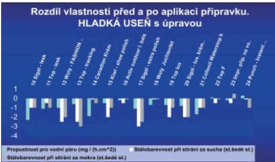
Přípravky č. 10 až 24 - větší rozlišení (z grafu č 3) u veličin propustnost pro vodní páru - PVP a stálost při stírání za sucha a mokra. Ve většině případů se jedná o snížení úrovně uvedených vlastností po aplikaci přípravku.
