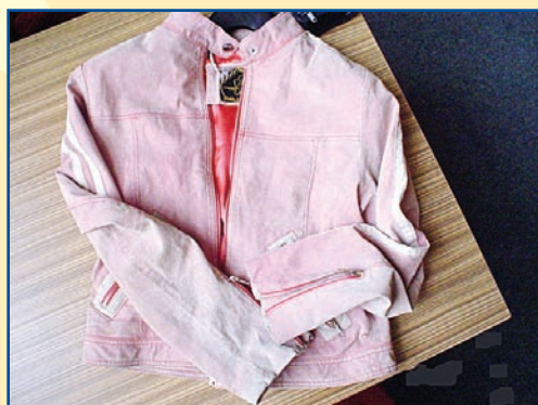
Bunda z vepřovicové štipenky po chemickém čištění, nestálobarevnost usně
