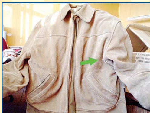
Snížená strukturální pevnost štipenkové usně, trhlina na rukávu
