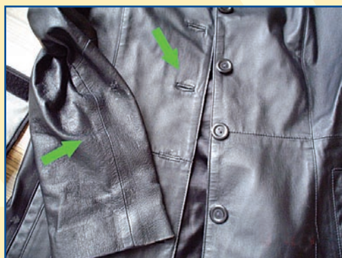
Slupování povrchové úpravy na rukávu a v okolí knoflíkových dírek
