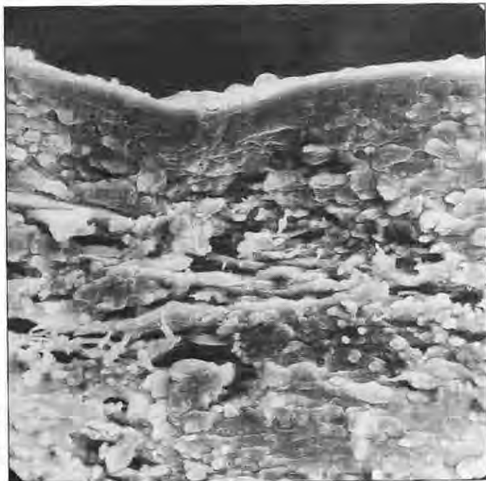
1 - Struktura řezu lícové vrstvy usně před extrakcí
