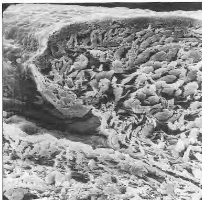
2 - Struktura řezu lícové vrstvy usně po extrakci
