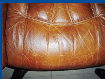
Křeslo - popraskaná povrchová úprava usně
