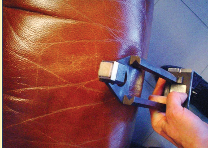
Křeslo - setřené místo po zkoušce stírání
