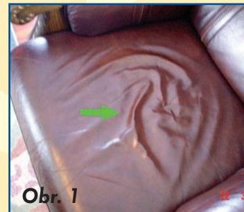
Obr. 1 Prázdná useň se zvýšeným lomem líce
