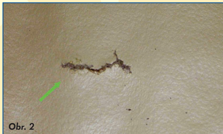
Obr. 2 Trhliny na sedáku vzniklé v důsledku nízké strukturální pevnosti usně (délka prasklin až 3 cm)
