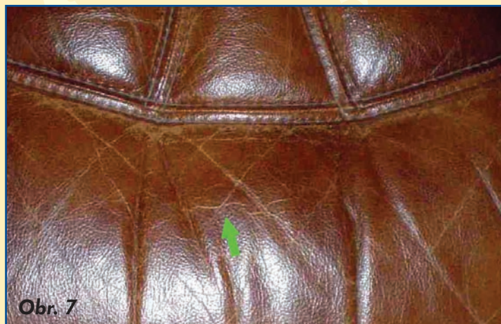
Jemné trhlinky povrchové úpravy
