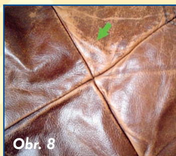
Snížená adheze povrchové úpravy
