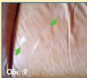
Stírání povrchové úpravy
